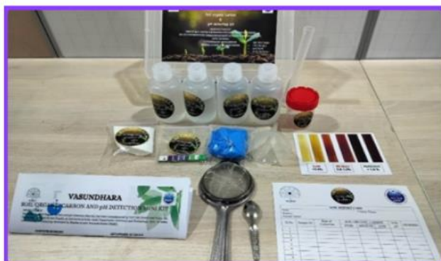
चित्र: वसुंधरा-मोबाइल मट्टी कार्बन पहचान किट जिसे BARC ने बकसित किया और नेक्टर को सौंपा गया
